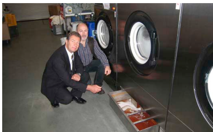
Der Rückgewinnungstank ist in der Sockelschublade integriert. Dieser erlaubt die mehrfache Verwendung der zum Beispiel mit Brandschutz oder mit Imprägniermitteln angereicherten Lauge.
